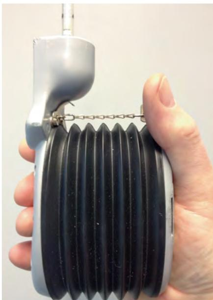
Abbildung 34: Messung mittels Prüfröhrchen und Handpumpe
