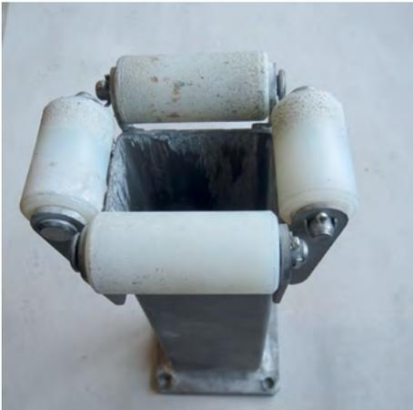
Abbildung 49: Rollenzuführung mit Stützen für Gummistreifen
