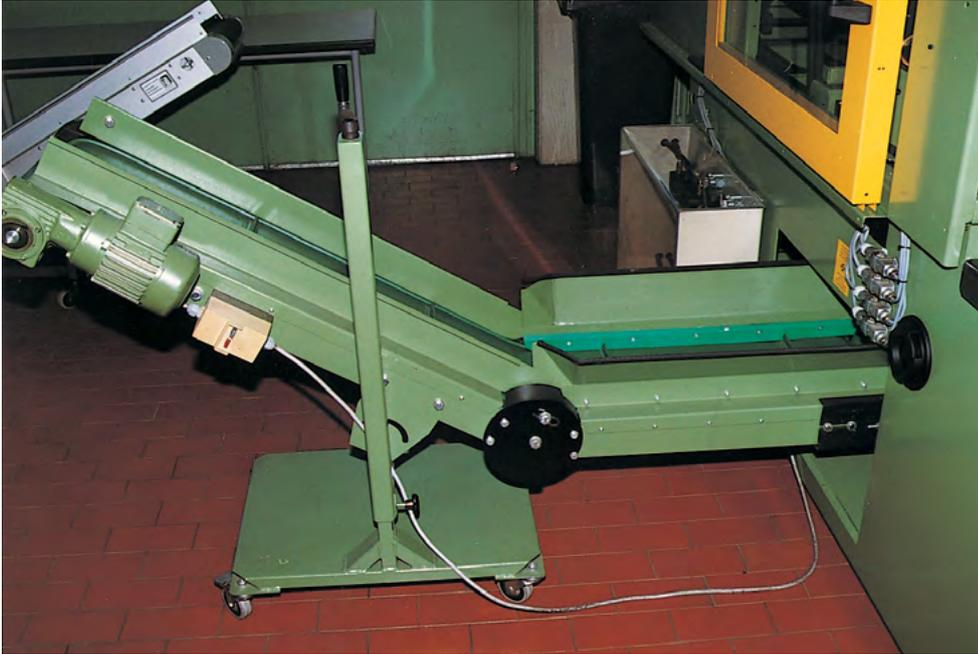
Abbildung 43: Spritzgießmaschine mit Formteilmförderung aus der Ausfallöffnung
