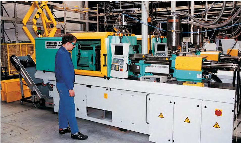
Abbildung 6: Spritzgießmaschine
