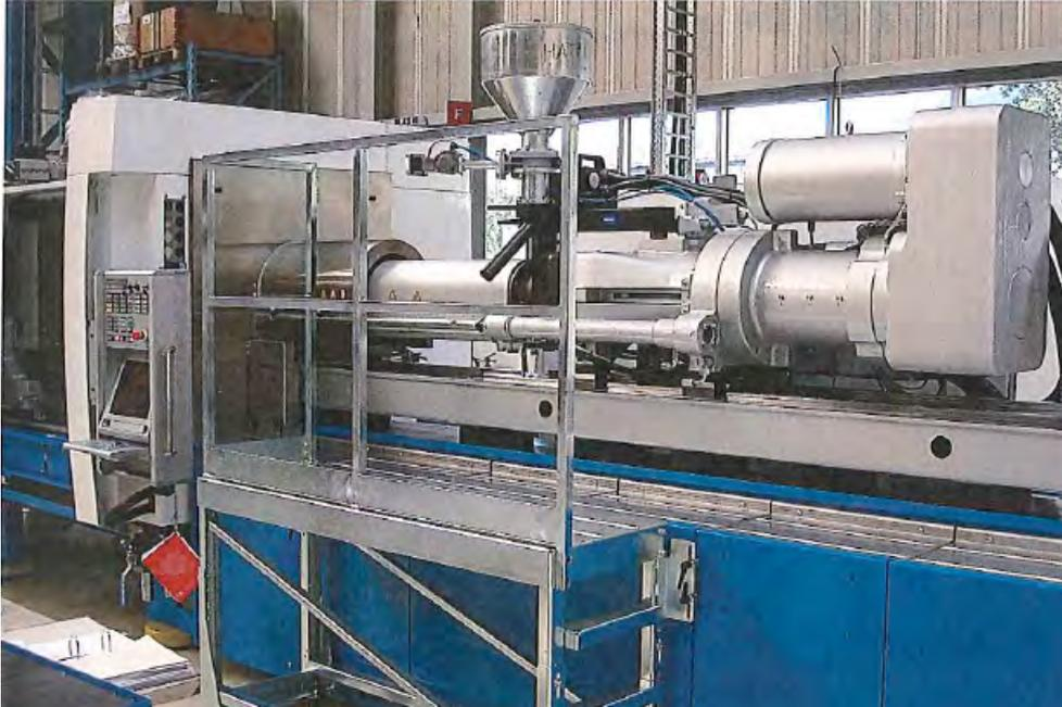
Abbildung 28: Fest montierte Aufstiegshilfe zum Granulatrichter
