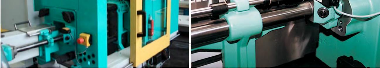
Abbildung 13: Typische Ausführung einer beweglichen verriegelten trennenden Schutzeinrichtung im Düsenbereich
