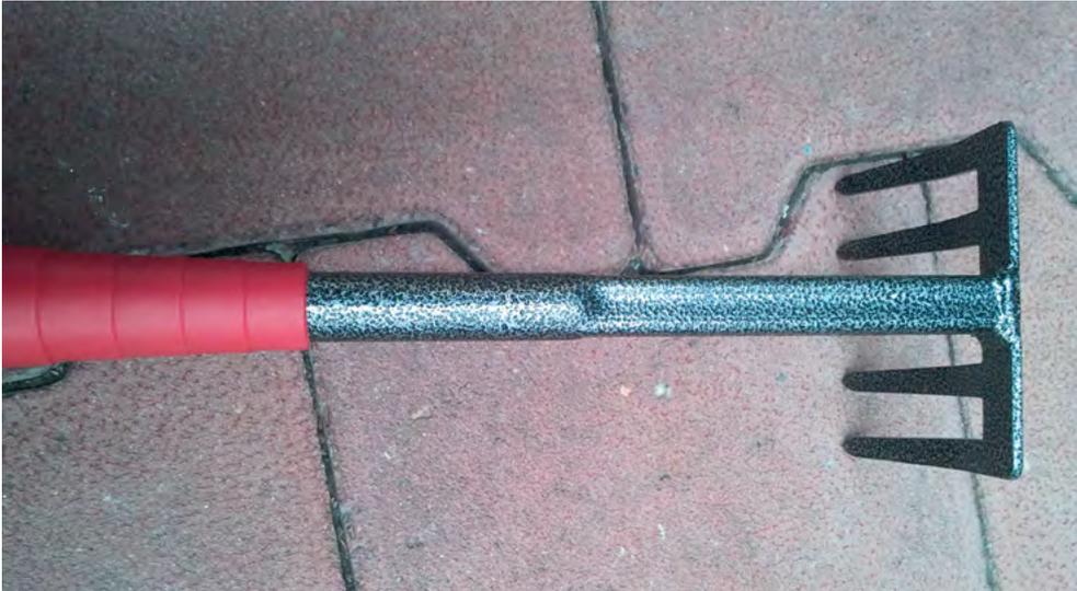
Abbildung 51: „Kralle“ zum Entfernen von ausgetretener flüssiger Formmasse
