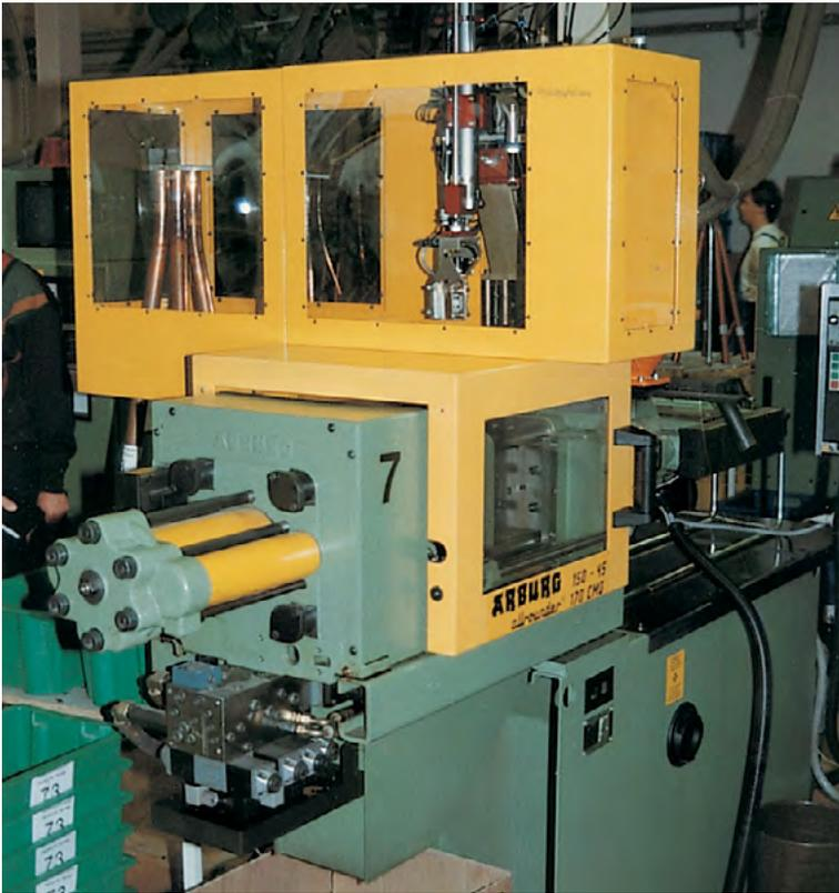
Abbildung 46: Tunnelhaube mit Erweiterung für Zusatzgeräte
