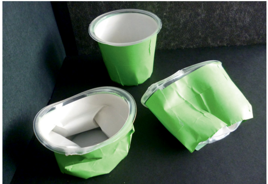
Mögliche Beschaffenheit des PLA-Papierverbund-Bechers bei Anknunft in der Sortieranlage (Bild: Fraunhofer IVV)
