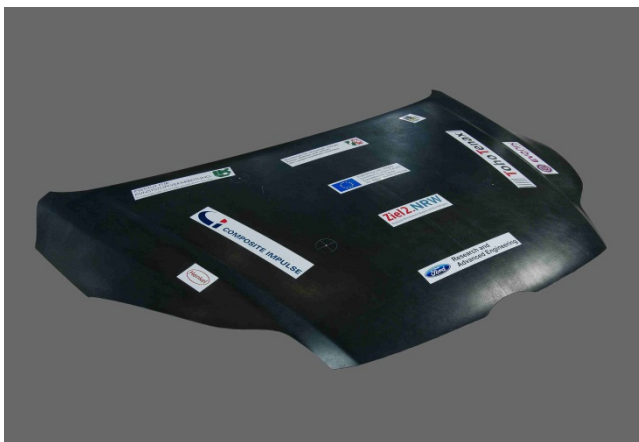
Prototyp einer CFK-Motorhaube (Bild: IKV)
