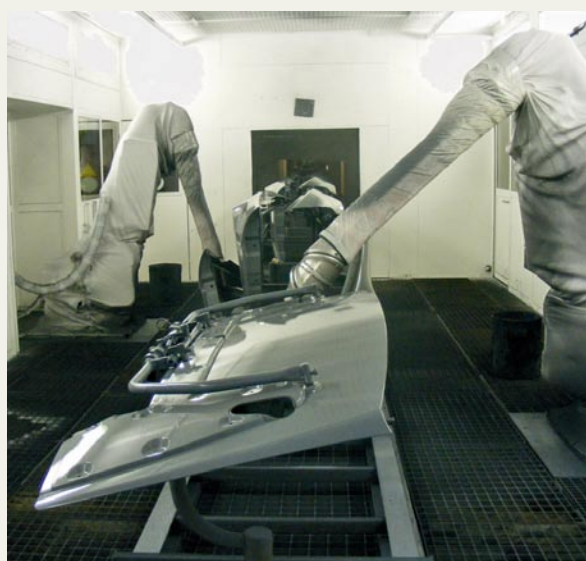
Der Haftgrundauftrag erfolgt mit mehreren Lackierrobotern
