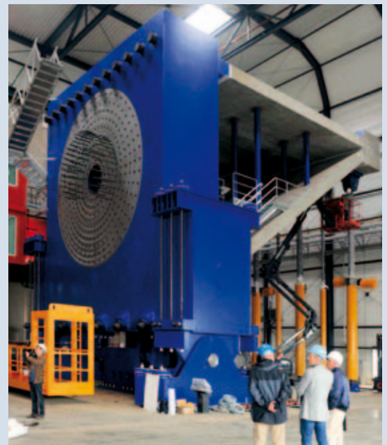
Abb. 4 Größenvergleich: Der kippbare Einspannblock ist 14 m hoch und wiegt 1.000 t. Quelle: Fraunhofer IWES
