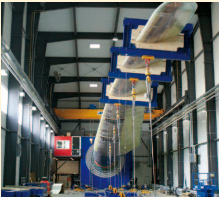
Abb. 3 Lastscheren umklammern ein 56 m langes Rotorblatt beim statischen Test; Stahlseile docken daran an. Hydraulikzylinder am Hallenboden übertragen die Last. Quelle: Fraunhofer IWES
