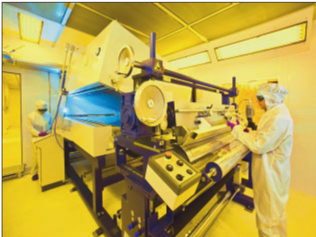
Beschichtungsanlage zur Herstellung nanostrukturierter Folien (Quelle: Bellhäuser)
