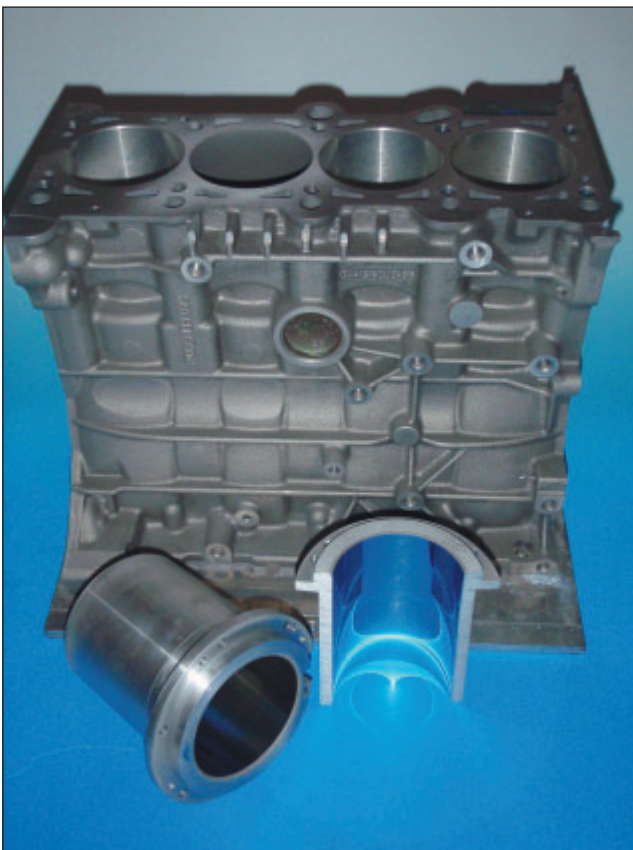
Prototypentwicklung eines Motorblocks mit nanobeschichteten Zylinderbuchsen (Quelle: Institut für Fertigungstechnik keramischer Bauteile, Universität Stuttgart)
