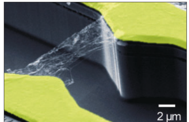
Kohlenstoff-Nanofasern zwischen zwei Goldelektroden als Basis für ultraschnelle Photodetektoren (Quelle: Alexander Holleitner/TU München)
