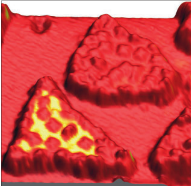
Rastertunnelmikroskopie-Aufnahme (50x50 nm 2 ) magnetischer organischer Moleküle mit unterschiedlicher Spin-Ausrichtung, die als Basis für zukünftige Datenspeicher dienen könnten (Quelle: CFN Karlsruhe)
