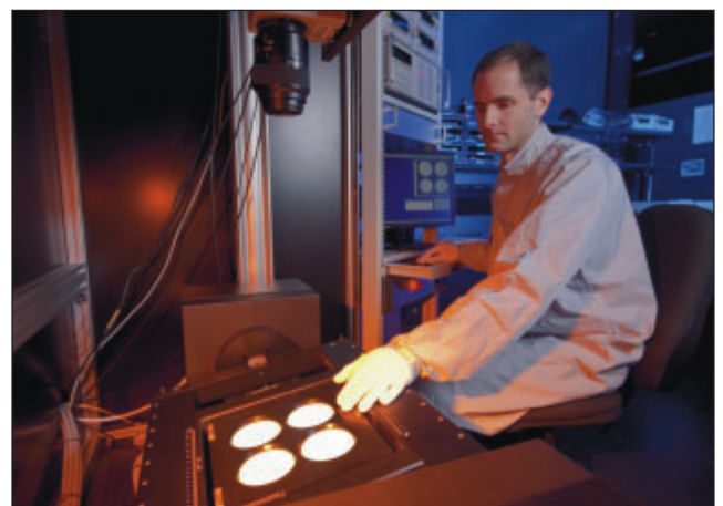
Elektrooptische Charakterisierung kommerzieller OLED-Beleuchtungskörper (Quelle: OSRAM)
