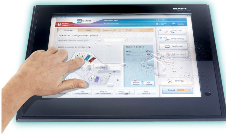
Bild: Bei den industrietauglichen GLASSCAPE-Touchscreens von RAFI führen auch aufspritzendes Wasser oder Schmutz zu keinen Fehlbedienungen. Die Multitouch-Geräte sind mit Bildschirmdiagonalen bis 24" erhältlich.
