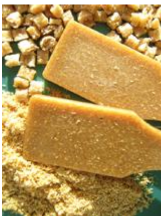
Spritzgossene Prüfkörper aus holzfaserverstärktem Kunststoff.
