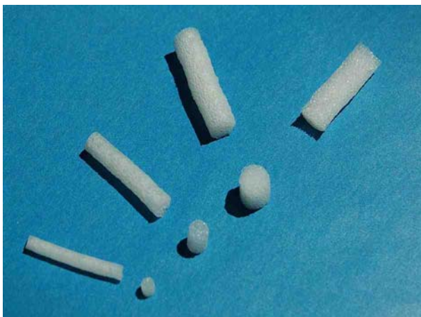
Physikalisch geschäumtes Profil aus Festsilicon (Bild: IKV)
