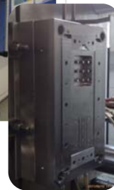
Versuchs- werkzeug mit umfangreicher Sensorik
