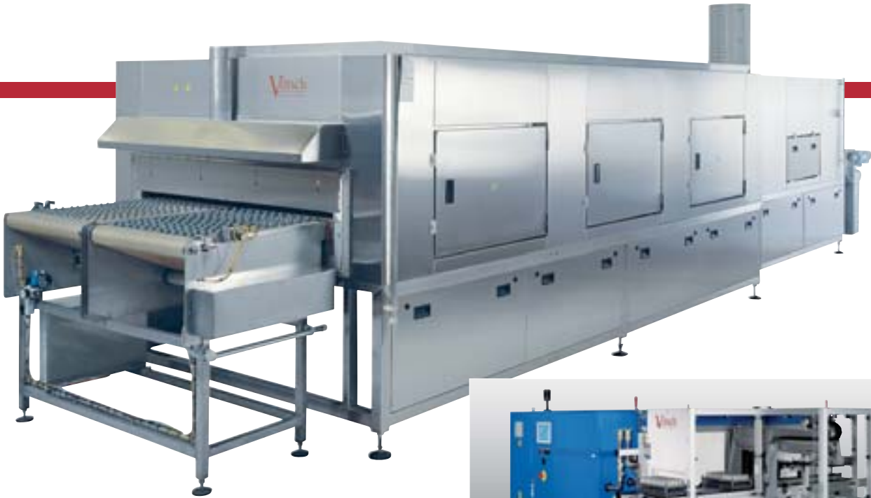
Reinraum-Durchlaufofen zum Aushärten von Verschlussstopfen für Arzneiflaschen
