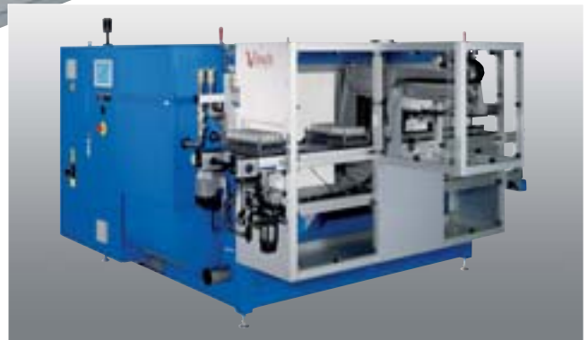
Durchlaufofen zum Tempern von Kompensatoren
