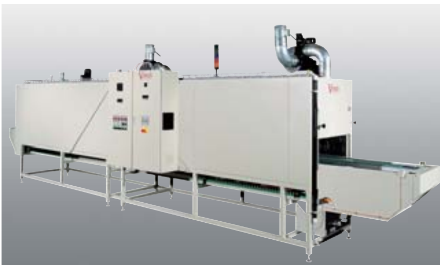
Durchlaufofen zur Klebeaushärtung in der Lampenproduktion
