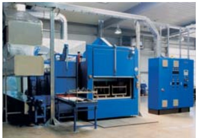
Durchlaufofen zur Vulkanisation und Formgebung von KFZ-Kühlmittelschläuchen
