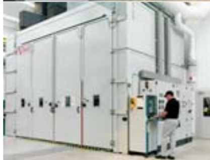
Temperofen mit herausfahrbarem Drehgestell zur Aufnahme eines CFK-Hubschrauber-Cockpits
