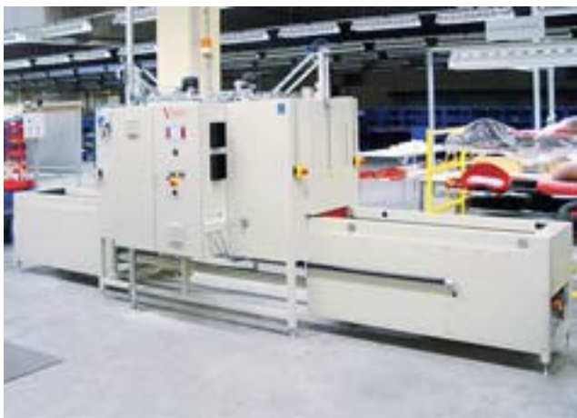
Durchlaufofen zur Kleberaushärtung an Armaturenbleetern
