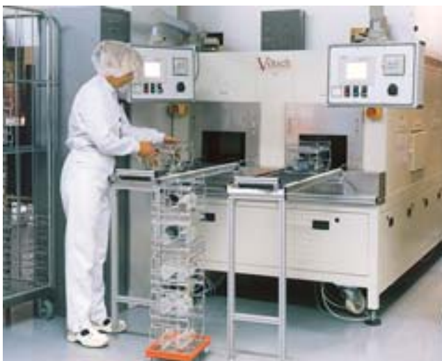
Reinraum-Durchlaufofen zur Aushärtung von Beschichtungen von Kunststoff-Brillengläsern
