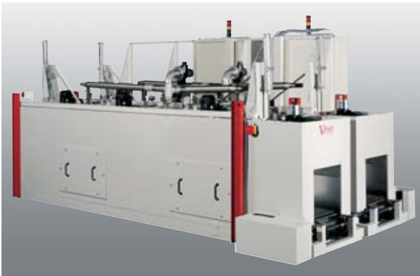
Doppel-Durchlaufofen zum Tempern von Kunststoffteilen
