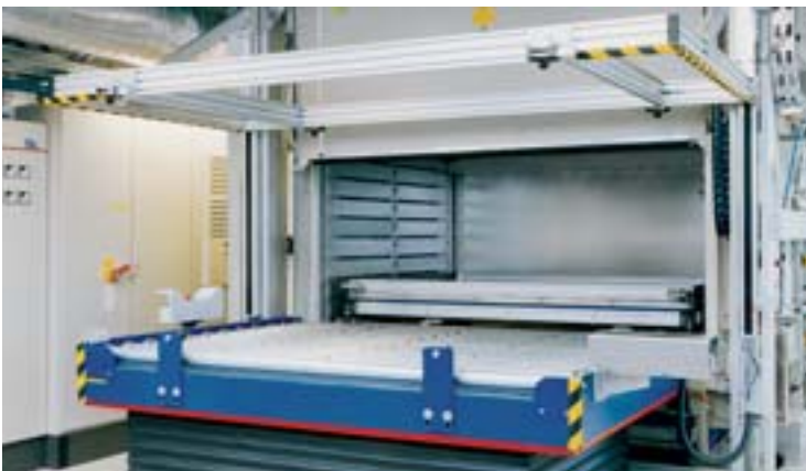
2-Zonen-Durchlaufofen zum Aushärten von Kohlefaser-Verbundwerkstoffen in Kombination von Heißluft- und Infrarotbeheizung
