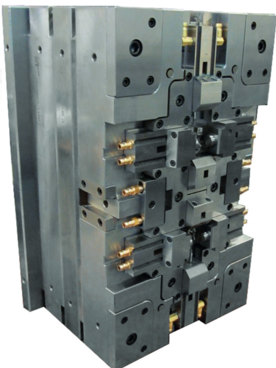
Bild 7: IsoForm®-Werkzeug mit Schiebern (Werkbild: Festo)
