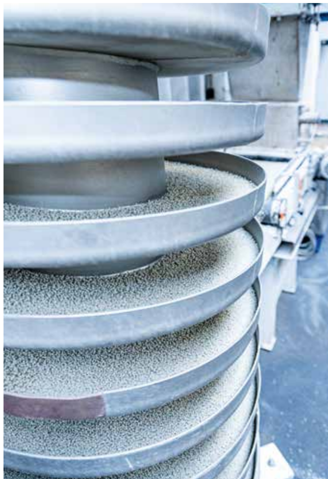
Im Wendelförderer kühlt das Stranggranulat endgültig ab, bevor es verpackt und an den Kunden ausgeliefert wird.
